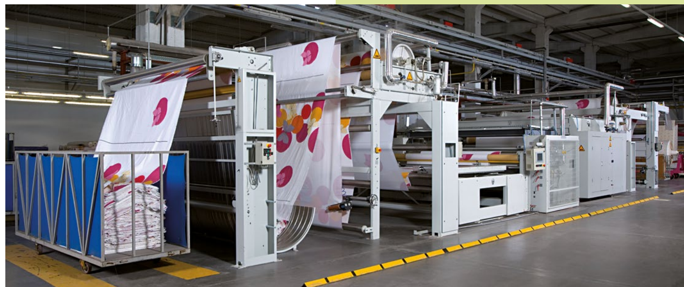
Sanfor-Anlage mit Warenmulde, Dämpftrommel und Vorspannfeld
