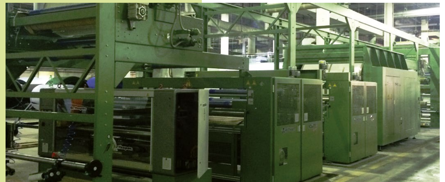
Doppel-Sanfor-Anlage zum Kompaktieren von speziellen Waren wie z. B. Artikel mit Flammschutzausrüstung
